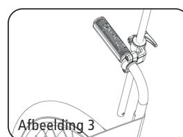
Door de stang met de beide scharnierende gewrichten kan bevestigingseenheid van MT-IN-SCHV22 (afbeelding 4) aan nagenoeg elke geschikte buis van het frame worden gemonteerd (afbeelding 5 en 6). Door de scharnierende gewrichten, is hij zeer individueel instelbaar. De stang kan op elk moment door losmaken van de snelspanner van de bevestigingseenheid losgemaakt en daarmee gedemonteerd worden, terwijl de bevestigingseenheid aan de rolstoel blijft.
