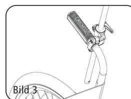
Durch das Gestänge mit den beiden Knickgelenken kann die Befestigungseinheit des MT-IN-SCHV22 (Bild 4) an nahezu jedes geeignete Rohr des Rahmens montiert werden (Bild 5 und 6). Durch die Knickgelenke ist er sehr individuell einstellbar. Das Gestänge kann jederzeit durch Lösen des Schnellspanners von der Befestigungseinheit gelöst und damit demontiert werden, während die Befestigungseinheit am Rollstuhl verbleibt.
