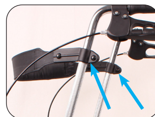
Gewünschte Gurthöhe einstellen und Schrauben der Rohrschellen festziehen
