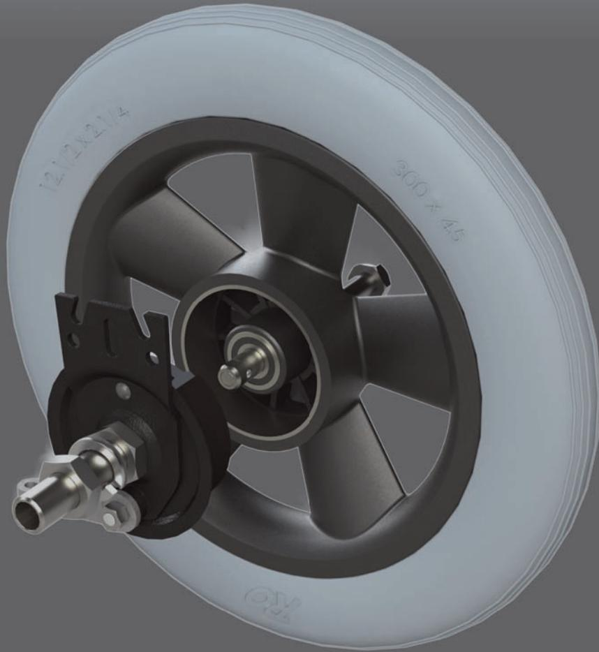
**Beispiel: Rad mit Kunststoff-Felge, Polyurethan-Reifen und Trommelbremse mit Quick-Release-Achse zum schnellen demontieren vom Bremsträger.** | Example: Wheel with plastic rim, polyurethane tyre, and drum brake with quick-release-axle for quick disassembly from break carrier.
