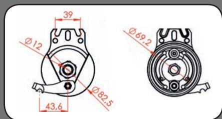
Trommelbremsnabe aus Stahl |
