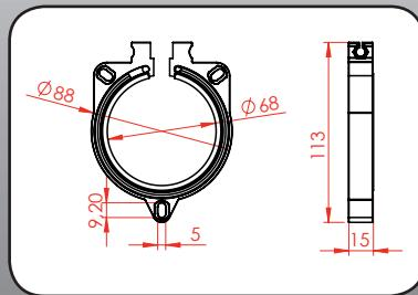
**Rolko-Naben-Bremssystem 1, mit Bremsband, schwimmend gelagert, für Bremsscheibe 68 mm** | Rolko hub brake system 1, with brake band, floating-mount, for brake disc 68 mm
