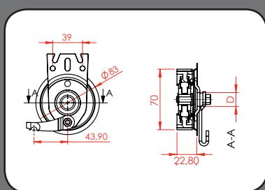
Bremsanker aus Stahl für Rolko-Kunststoff-Felgen | Brake torque receivers in steel for Rolko plastic rims
