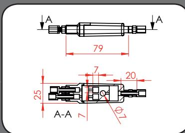
**Weiche aus Kunststoff mit Einstellschrauben, für 2 Bowdenzüge mit Tonne 6 x 7 mm** | Switch in plastic with adjustment screws, for 2 bowden cables with barrel 6 x 7 mm
