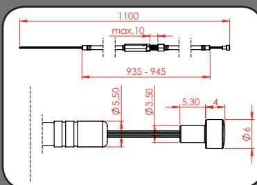
**Stahlseil, für Rollatoren, mit Einstellschraube** | Steel wire, for rollators, with adjustment screw
