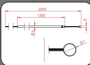
**Stahlseil Ø 1,25 mm, für Auslösehebel, mit Tonne** | Steel wire, Ø 1,25 mm, with release lever for barrel fit
