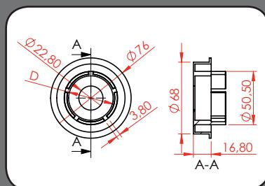
**Bremsscheibe, aufsteckbar auf Rolko-5-Speichenfelge** | Brake disc, to plug at Rolko 5-spoke rim
