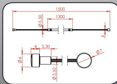
**Stahlseil Ø 1,5mm, universal, Tonnen- und Birnennippel** | Steel wire Ø 1,5 mm, universal, barrel- and pear shape cable-head
