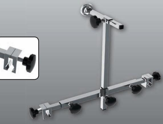
**Haltesystem aus Aluminium mit Rohraufnahme bis zu 38 mm Rohrdurchmesser und Schiebegriffe mit Verstellbereich 400-570 mm, inklusive Kugelkopf Ø 25 mm mit Schelle. System höhenverstellbar bis max. 350 mm.** | Restraining system in aluminium for tube fit up to Ø 38 mm and 400 - 570 wide push handles; height adjustable up to 350 mm. Ball head Ø 25 mm with clamp included.
