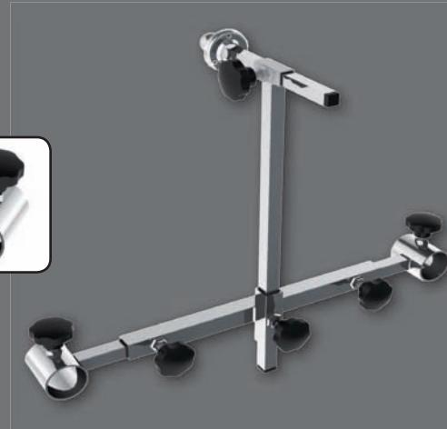
**Haltesystem für Sitzrücken, max. 350 mm höhenverstellbar, inkl. Befestigungsplatte mit 8 Befestigungspunkten. Kugelkopf Ø 25 mm mit Schelle.** | Restraining system for back rests; height adjustable up to 350 mm, including mounting plate with 8 fixation points and ball head Ø 25 mm with clamp.
