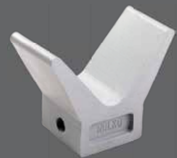
Boegsteen met 82 graden opening, zijlengte 50 mm, voetstuk met dwars gat van 10,5 mm | Rubber bow stop with 82 degree opening, side length 50 mm, pedestal with cross hole of 10.5 mm
